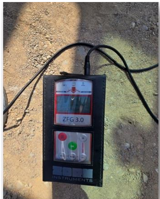
13-сурет – Бетон құю алдындағы топырақтың сапасын зертханалық тексеру
