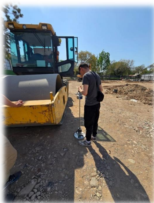
13-сурет – Бетон құю алдындағы топырақтың сапасын зертханалық тексеру
